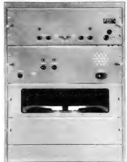
Bild 3. Automatisches Zeitanagegerät für Telefonzentralen (Assmann GmbH)
